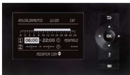
La nuova regolazione Vitotronic permette una chiara visualizzazione delle fasce orarie
