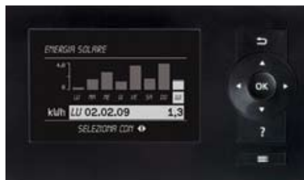
Nuova regolazione Vitotronic di semplice utilizzo grazie a una facile navigazione e al display in grado di visualizzare anche grafici, relativi ad esempio al rendimento solare.
