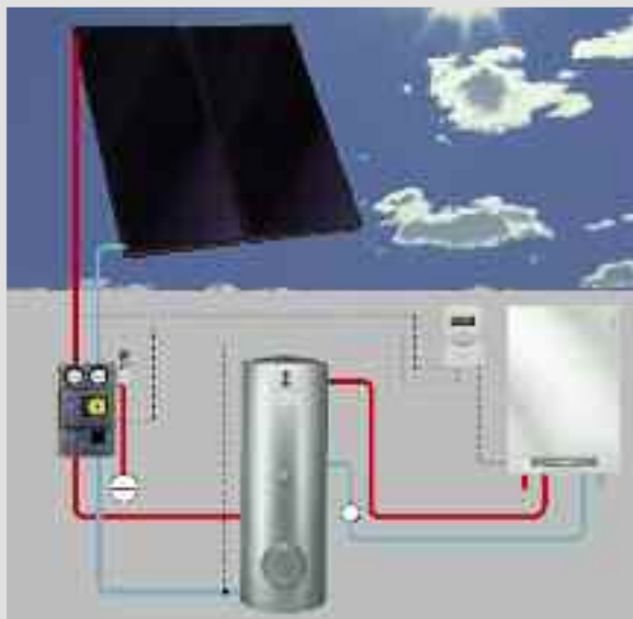
Figura 15: Impianto solare completo: collettore solare, stazione-pompa Solar-divicon, bollitore, regolazione Vitosolic, collegamento a caldaia a condensazione Vitodens
