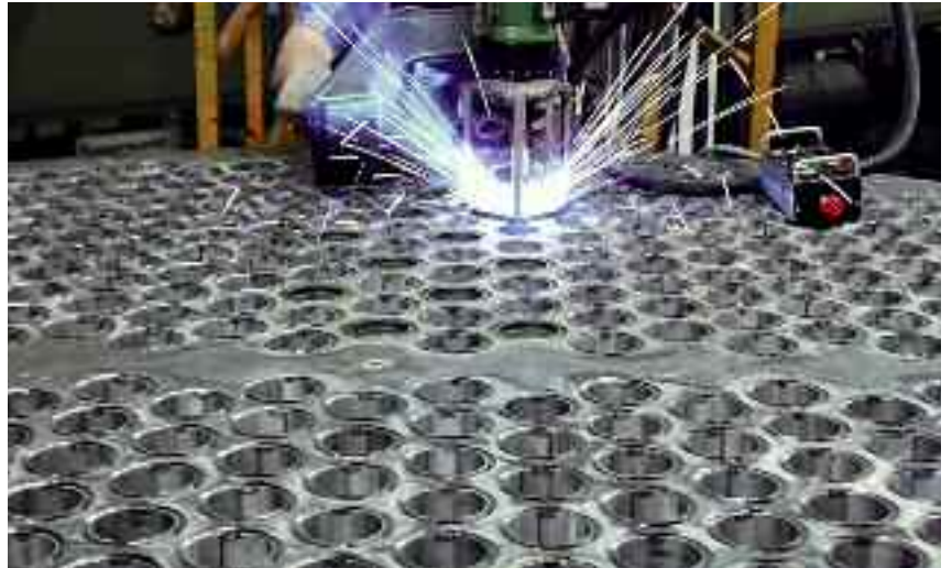
Saldatura tubi fumo alle piastre
