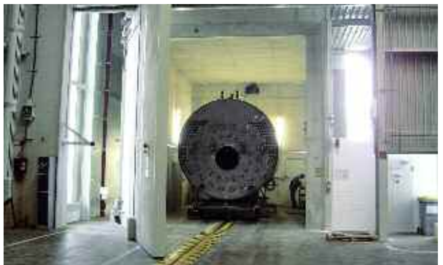
Caldaie sottoposte a test radiografico
