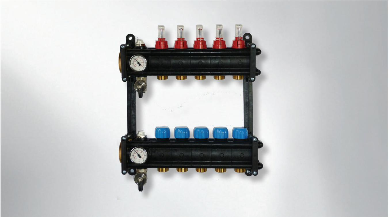
Collettore modulare in PA66 con visualizzatore di portata sulla mandata (0-5 L/min) e comando termostattizzabile sul ritorno.
