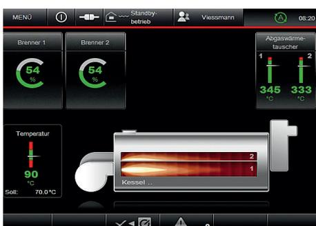
Vitocontrol HS in applicazione per le caldaie Viessmann a doppio focolare
