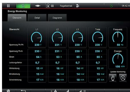
L'Energy Monitoring consente di controllare in ogni momento i dati di funzionamento dell'impianto
