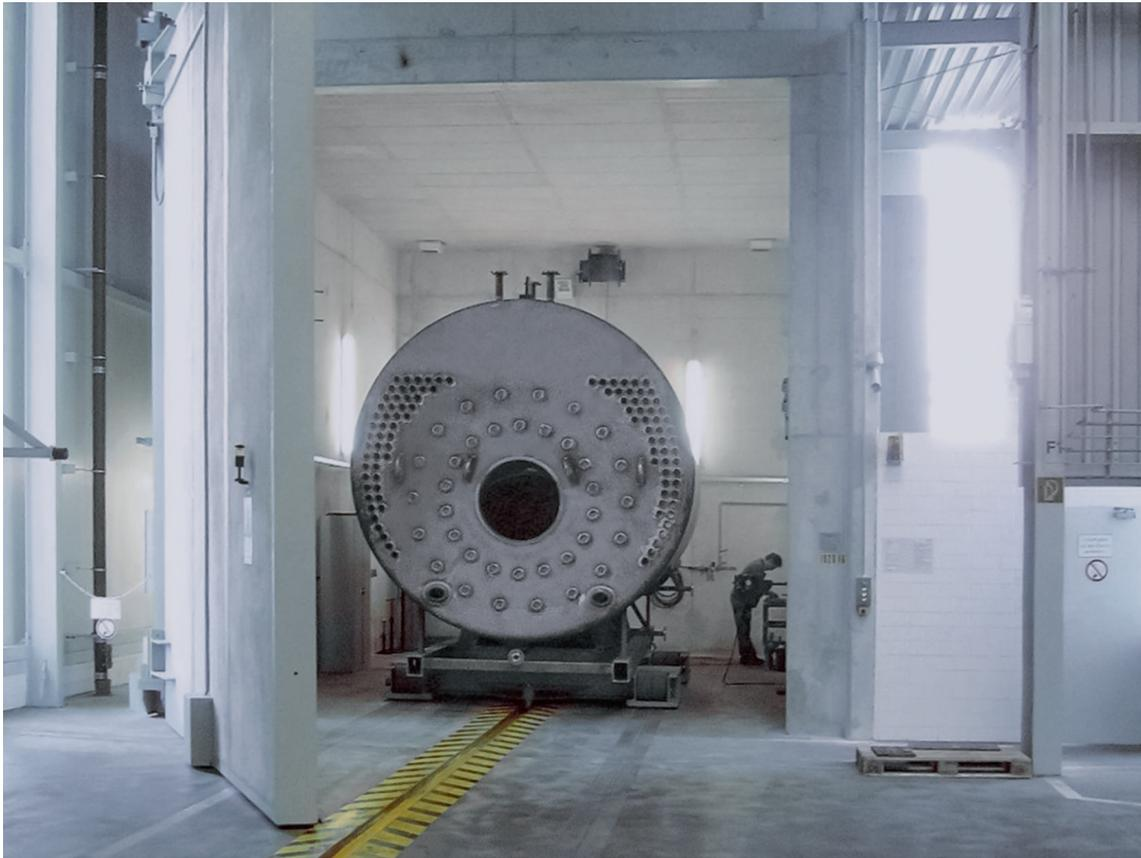
Nella camera a raggi X si rilevano eventuali difetti dei cordoni di saldatura o dei materiali dei singoli componenti della caldaia Vitomax
