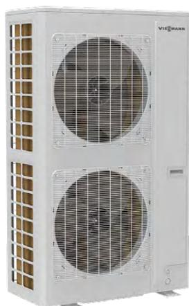
Utilizzano la tecnologia DC inverter, appositamente sviluppata per Vitoclima 333-S, che permette di raggiungere elevati livelli di efficienza. Capacità di raffrescamento: 12,1 kW - 14 kW - 16 kW (4HP - 5HP - 6HP). Il protocollo di comunicazione CAN BUS garantisce velocità ed affidabilità. Grande flessibilità d'installazione: Lunghezza totale delle tubazioni: 300 m Lunghezza delle tubazioni tra l'unità
